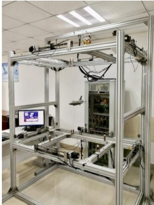
图 1 绳牵引并联机器人原理样机
