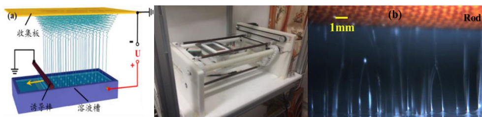
非接触电纺装置原理图、设备与喷射射流
