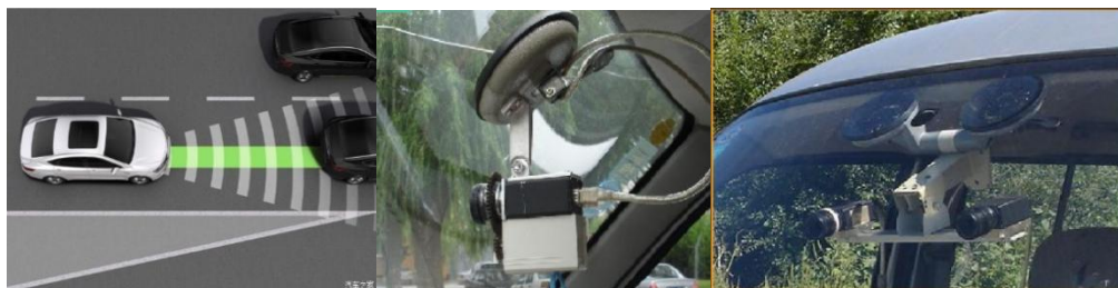
无人驾驶车载单目视觉运动物体检测 车载双目视觉运动物体检测
