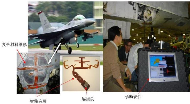
图 3. F-16 上补片健康监测的飞行试验
