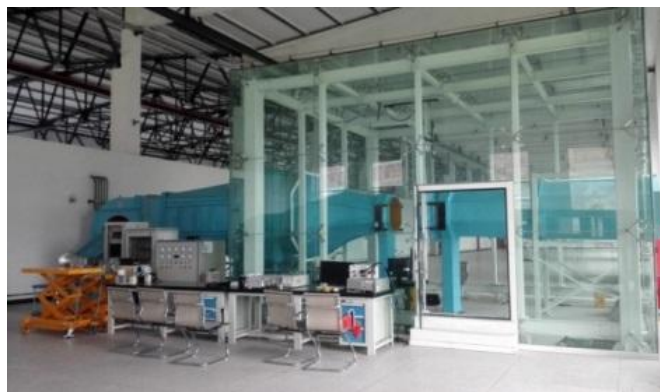
图2 风洞试验绳牵引并联机器人支撑系统
